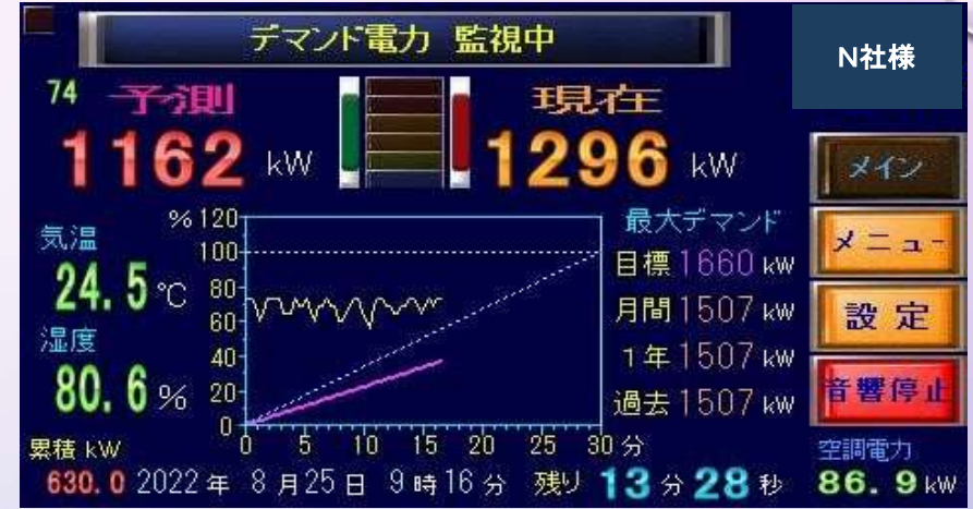
温湿度トランスミッタ(特許取得)により、計測データも表示
